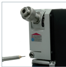
Ajuste preciso en lo stick-out
