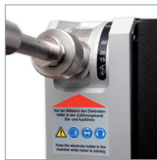
Plato centralizador triplica el uso del disco de diamante.
