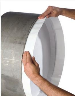
Retirar con cuidado parte de la cinta de la presa de la pared lateral del tubo.
