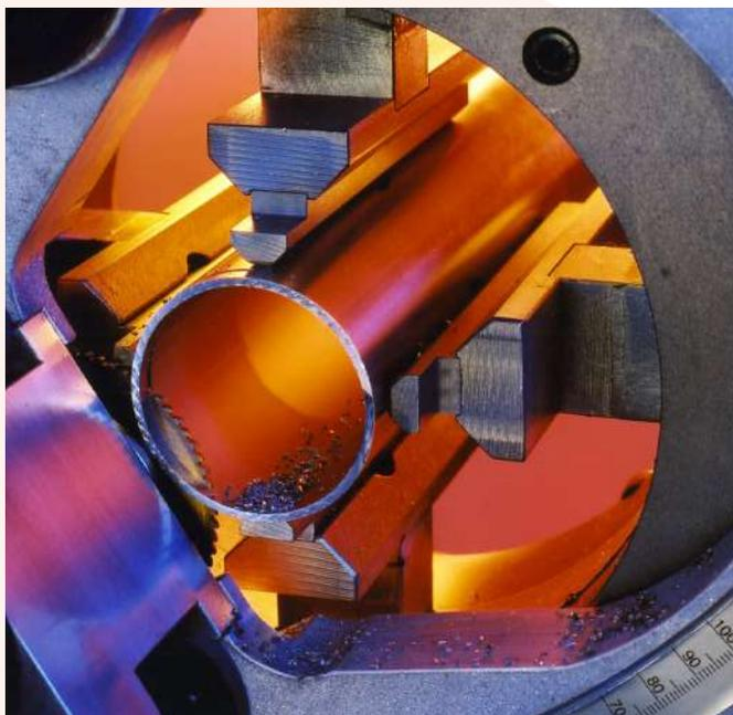
Se requiere esta precisión con el fin de permitir que la máquina de soldadura cierre con un golpe seguro la junta y conseguir así una estanqueidad perfecta de soldadura. El corte orbital se adapta bien a las exigencias de una soldadura automática. Esta preparación se utiliza para los tubos de un espesor inferior a 3 mm.
