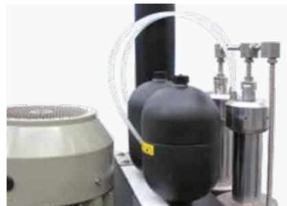
Acumulador de nitrógeno para la gestión del circuito de retorno de los cilindros hidráulicos
