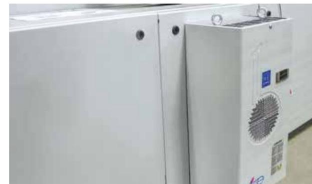
Acondicionador del armario eléctrico de la mesa de corte para temperaturas ambiente comprendidas entre 35 °C y 40 °C.
